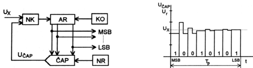
Obrázek 1. AČP s postupnou aproximací (a) blokové schéma; (b) průběh vyvažování
